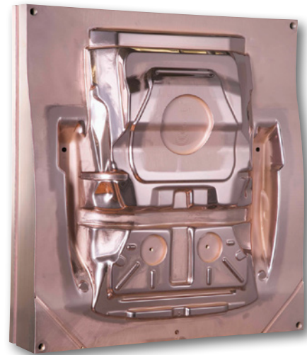
Material de trabajo: acero laminado en caliente 1.0335
