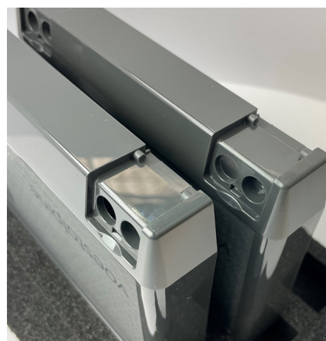
Abb. 2: ABS-Kunststoffformteile, gefertigt mit TiN-beschichtetem (links) und CHROME-X®-beschichtetem (rechts) Werkzeug
