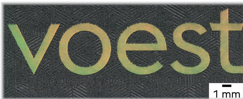
Abb. 3: Präzise Abformung von Texturen und Hologrammen auf ABS-Kunststoffformteil
